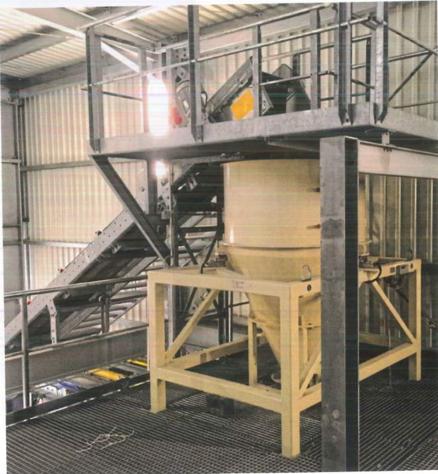
Die Differentialwaage sorgt für die geregelte Beschickung des Drehrohrofens.
