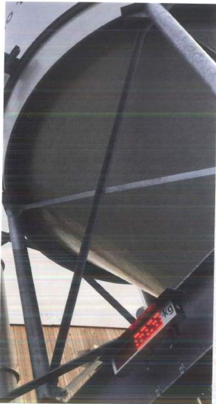
LED-Großanzeige zur besseren Ablesbarkeit des aktuellen Silofüllstandes
